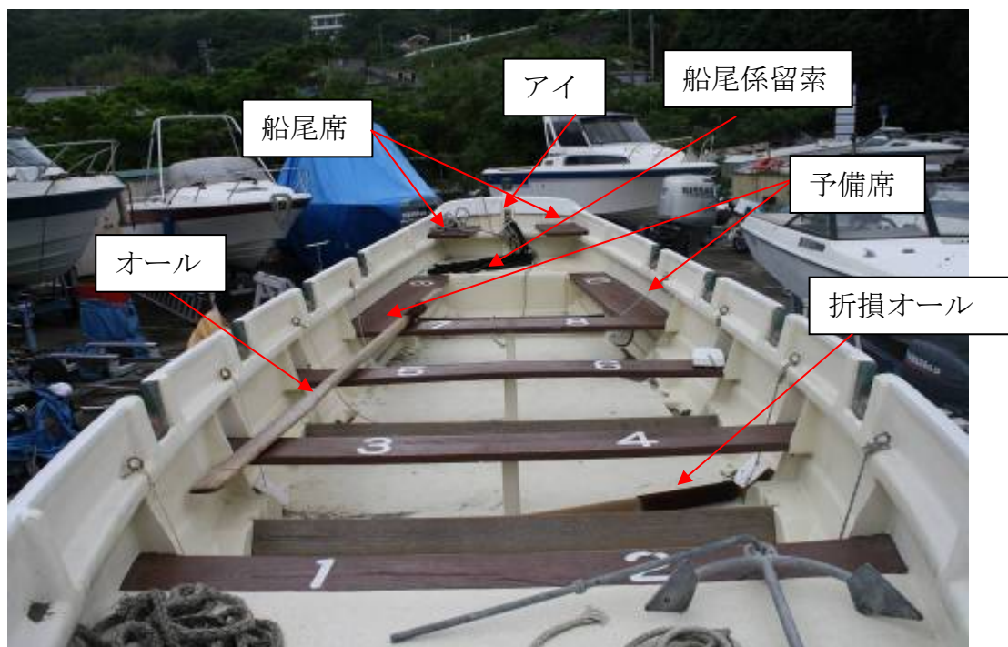
写真5 A船（船内船尾側）の状況
