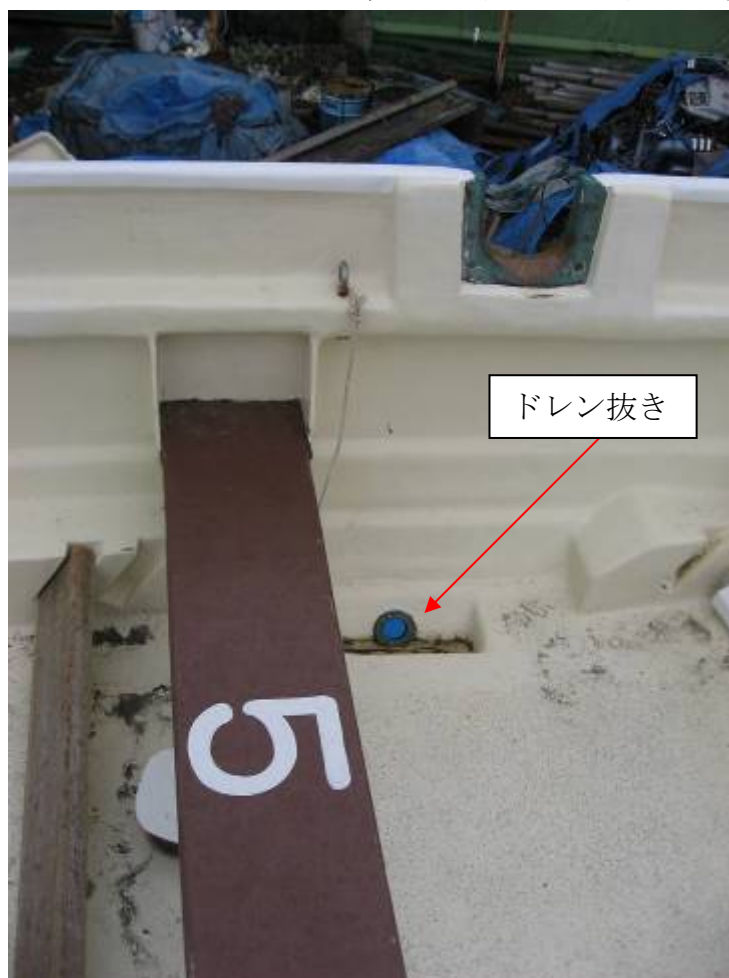
写真6 ドレン抜き（左舷側）の状況
